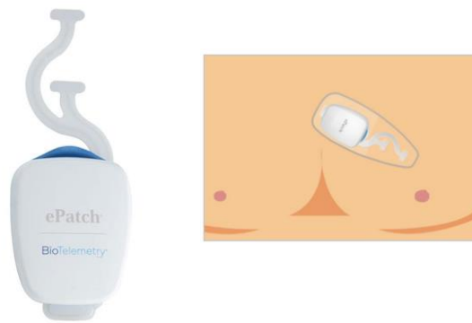
Afbeelding 2. De ePatch (links) en hoe deze op de borst geplakt wordt (rechts).
