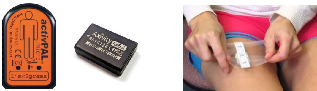
Afbeelding 1. De beweegmeter (links) en hoe deze op het bovenbeen geplakt wordt (rechts).
